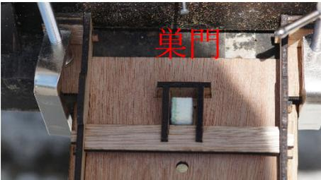
左の写真は装置の上蓋を外し上から見た図です。中央の緑のラインが入った白いものが、忌避剤を吸い上げ、蒸散させます。
